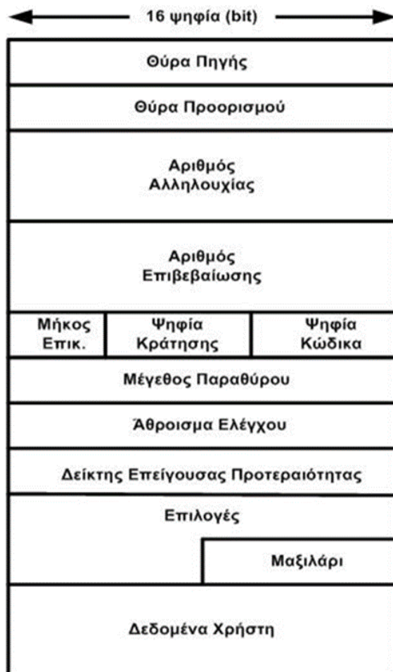
Εικόνα 1.37 – Το πακέτο TCP (Επικεφαλίδα και δεδομένα).
