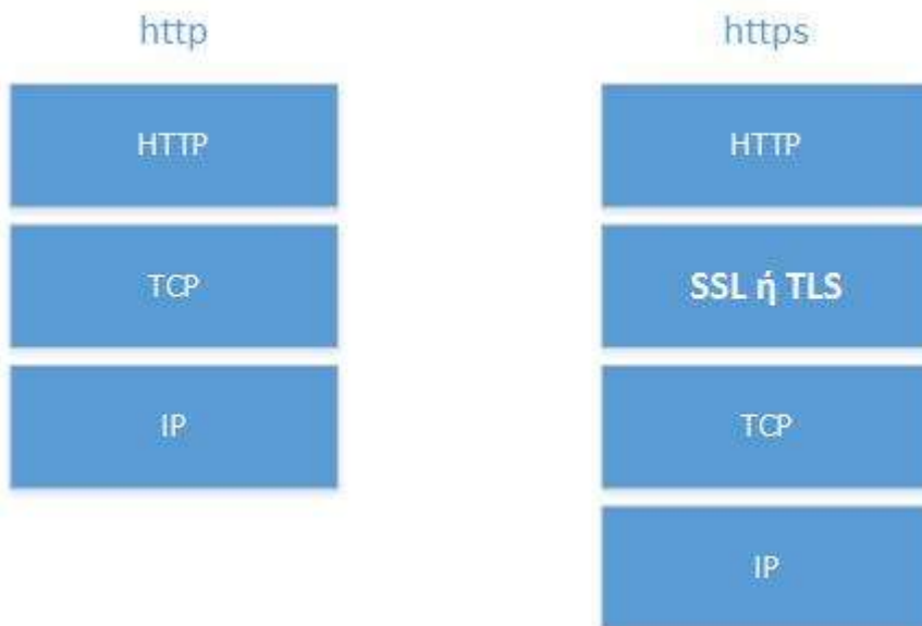
Εικόνα 2.5.2. Διαφορά του Πρωτοκόλλου Μεταφοράς Υπερκειμένου (HTTP) με το Ασφαλές Πρωτόκολλο Μεταφοράς Υπερκειμένου (HTTPS)
