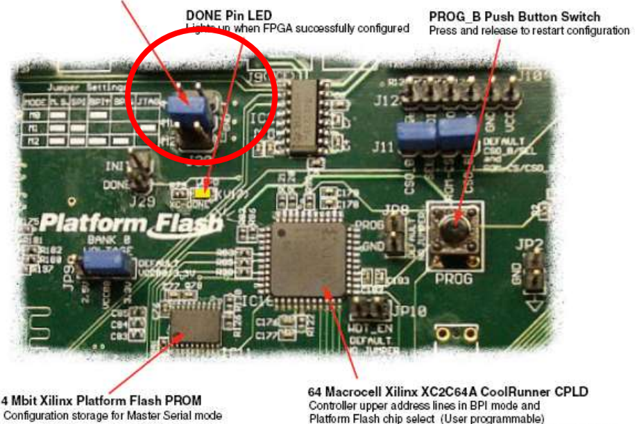
Εικόνα 16: Τοποθέτηση jumper της αναπτυξιακής πλακέτας
